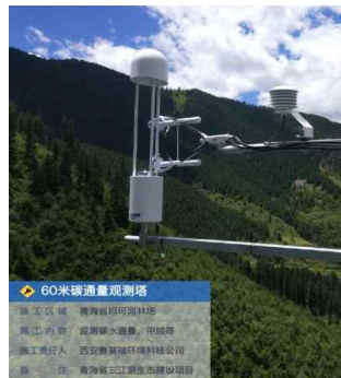
CSI梯度涡动站 施工区域：青海大青海湖监测 施工内容：观测涡动 风温湿梯度等 施工负责人：西安赛莫瑞环境科技公司
